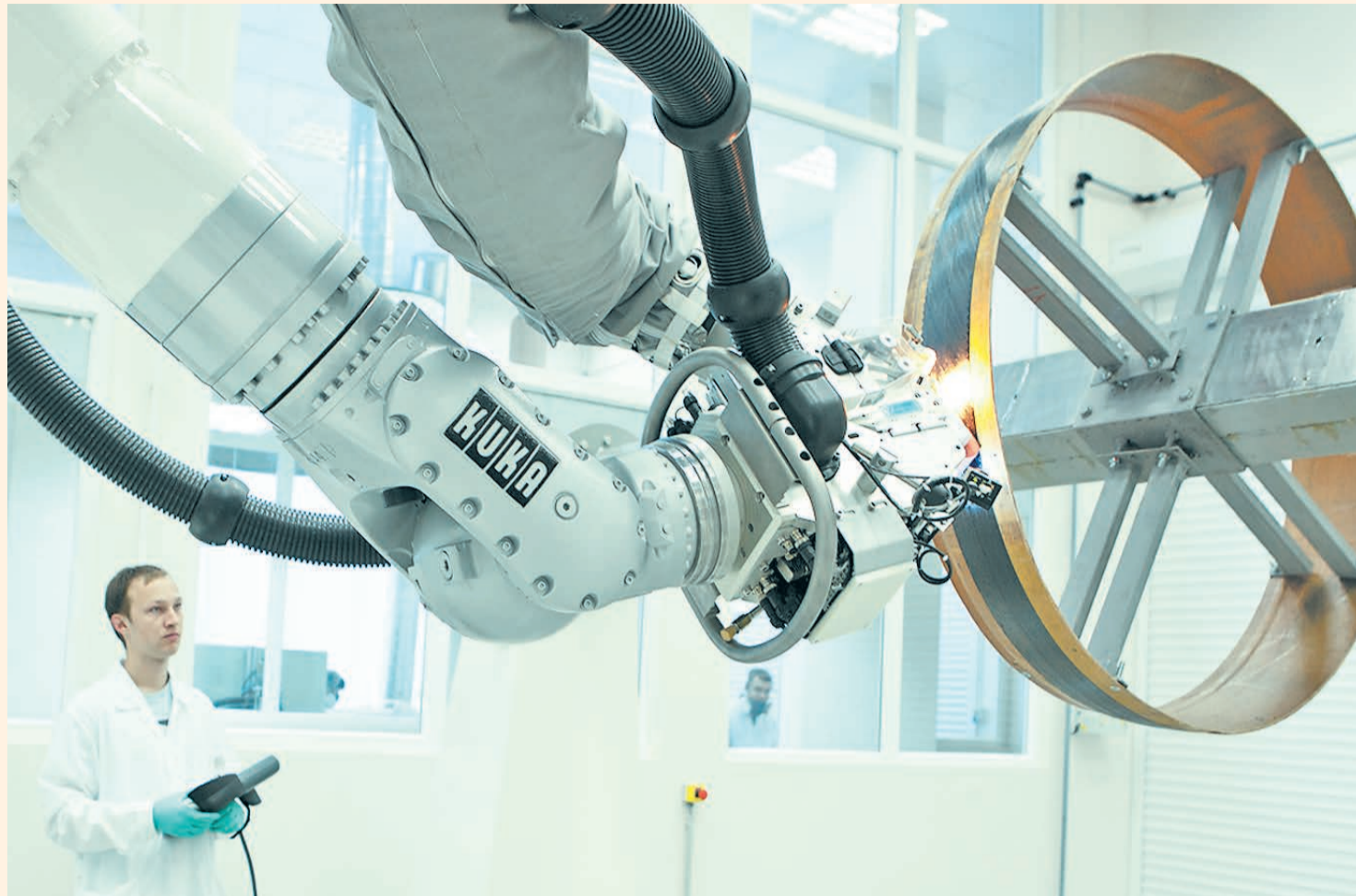
Роботизированная установка уже настроена на производство первых узлов мотогондолы ПД-14
