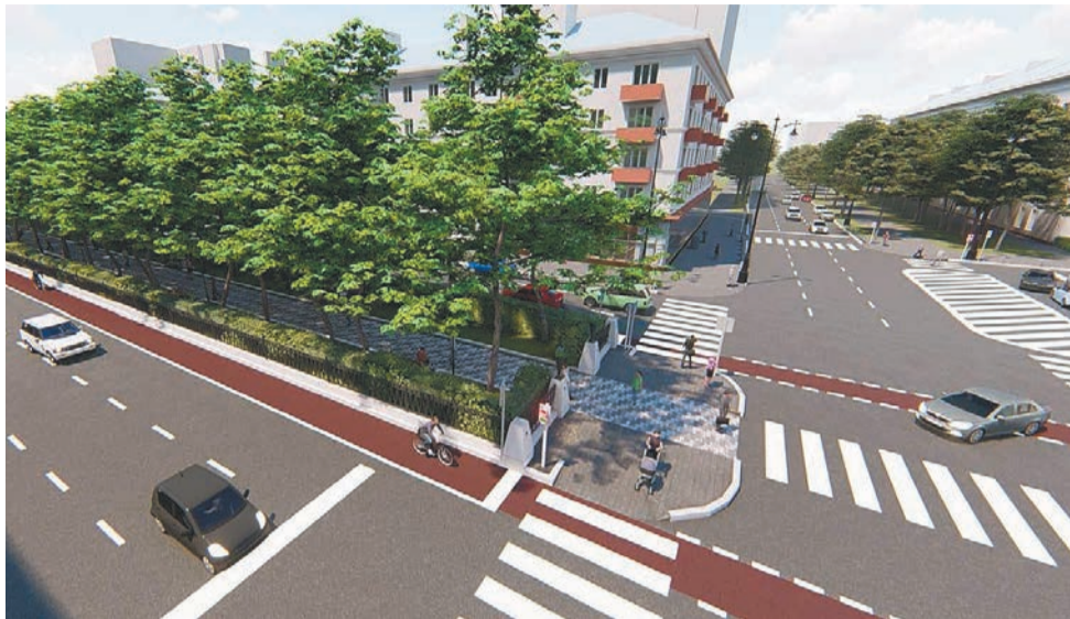
С помощью разметки и покрытия аллея на Комсомольском проспекте будет выглядеть непрерывной даже на перекрестках
