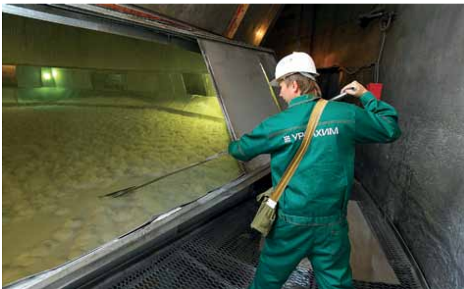
Охлаждение гранул карбамида на «кипящем слое»
